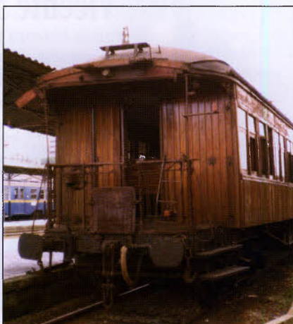
“Balconcillo” de un coche de viajeros de madera tipo “Costa”. Eran los comunmente empleados en los trenes “de las doce” y “de las cinco”.
